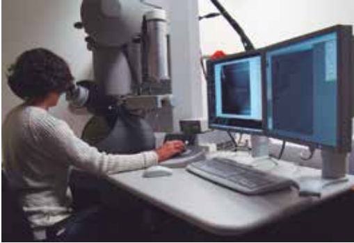
Figura 1.3 Un nuevo microscopio electrónico de transmisión (TEM) Modelo FEI TECNAI F20 -el más moderno de su tipo en el país hasta el momento- fue instalado en el CAB, en el edificio Ciencia y Tecnología de Materiales “Daniel Esparza”, en la División Metales, de la Gerencia de Física. http://www.cab.cnea.gov.ar/index.php/noticias-prensa/ultimas-noticias
